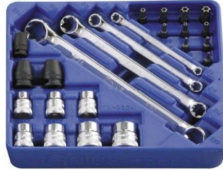
24 P.Torx lokma ve bits uç seti 3/8" Torx lokma: E.10-11-12-14-16 18-20 1/4"Torx uç: T.8-10-15-20-25-27 30-40-45-50 İkibağ torx anahtar: 6x8-10x12 14x18-20x24 Bits uç adp. (3)
